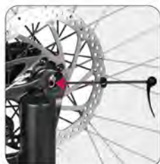
Mettez la poignée de dégagement rapide dans le pneu
