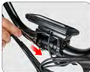
Serrer les 4 vis pour fixer le guidon
