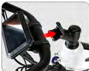
Installer le guidon pour régler la direction
