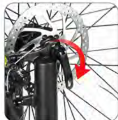
Verrouillez la poignée de dégagement rapide pour terminer l'installation de la roue avant
