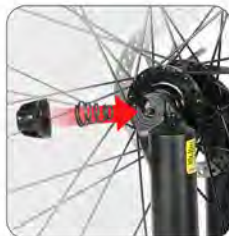
Serrer le ressort et l'écrou à la vis
