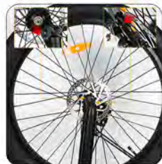
Installez le côté avec le disque de vélo électrique dans la direction avec le frein à disque
